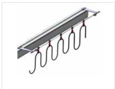
电源输送:钢丝绳拉板支架+吊线滑车+扁平电缆
